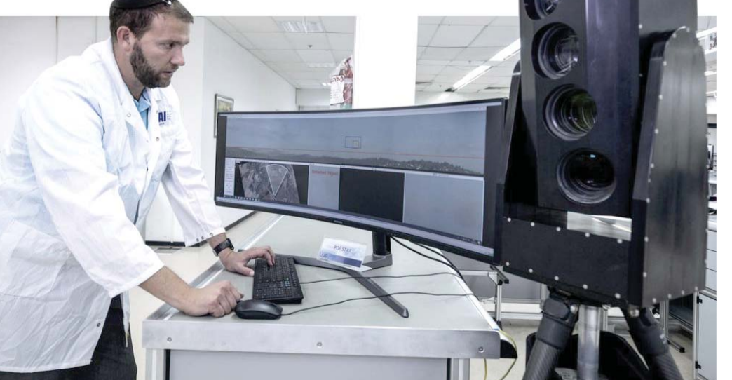
مكعب أسود يشبه مضخم صوت مضغوط يمكنه رصد طائرة ذاتية القيادة على بعد عدة أميال
